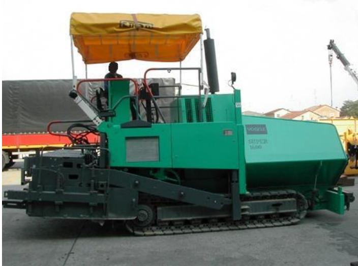
Gleichmäßige Verteilung durch Einsatz eines geeigneten Fertigers
